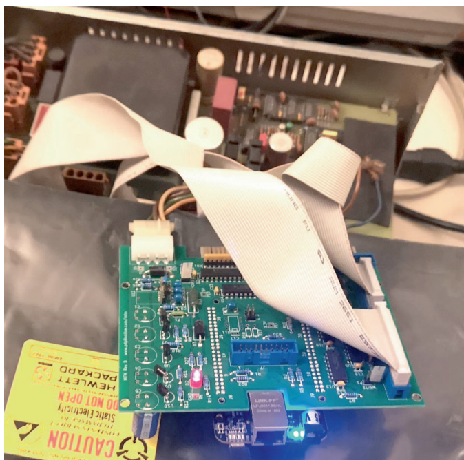
Aufbau zum Auslesen der Festplatte des CTM 9016
