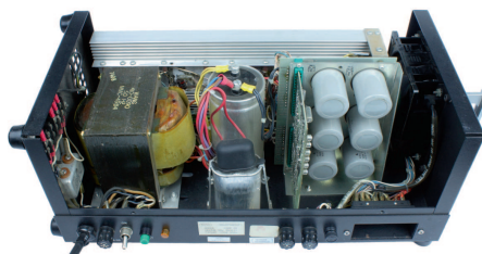
Geöffnetes Netzgerät mit Transformator und Längsregelung
